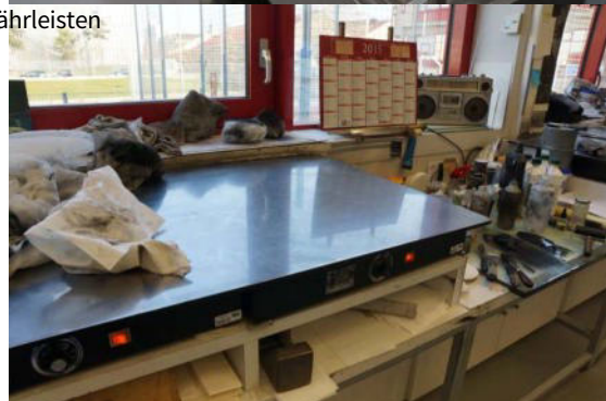
Tintenvorbereitung; der Farbtisch verfügt über eine Vorheizfunktion, um die Viskosität der Tinte zu verringern.
